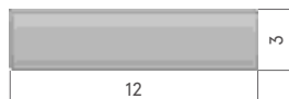
914.170 PIATTINA PER SERRATURA IN ACCIAIO STEEL BAR FOR LOCK PROFILE EN ACIER POUR SERRURE
